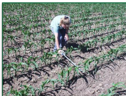
Figura 6. Medición de la Radiación Fotosintéticamente Activa e Índice de Área Foliar desde el centro de la hilera de cultivo hasta el centro de la hilera contigua.
